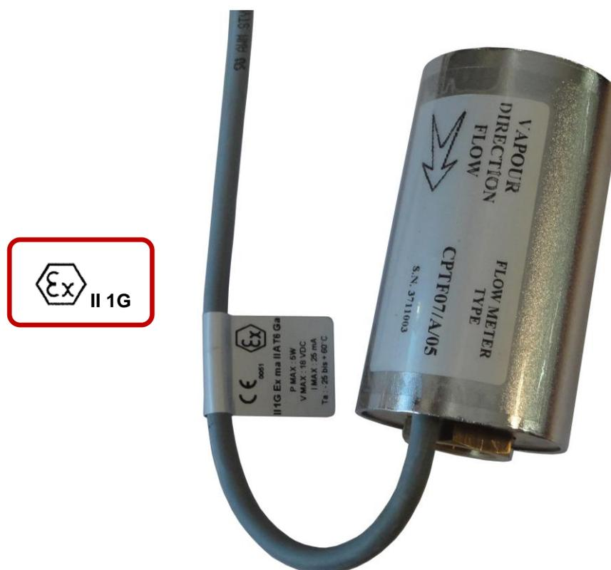
Sensore di misura della portata e della temperatura del vapore di idrocarburi in un range prestabilito.
